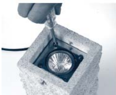
3. Schrauben der Dichtungsplatte entfernen
