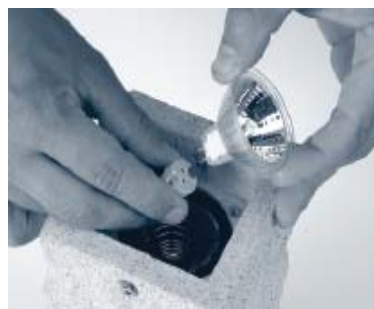
6. LED-Einheit abziehen und neue Einheit aufstecken.
