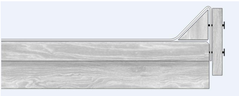
Ortgang mit Holzkeil und Windbrett Mechanisch fixiert.
