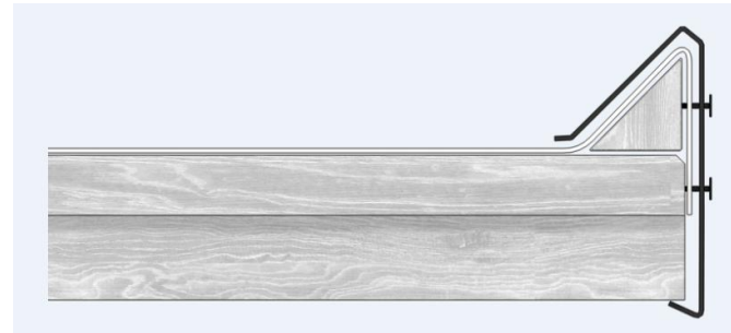
Ortgang mit Holzkeil und Metallabdeckung Mechanisch fixiert.
