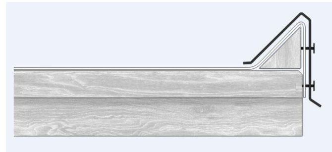
Ortgang mit Holzkeil und Metallabdeckung Mechanisch fixiert.
