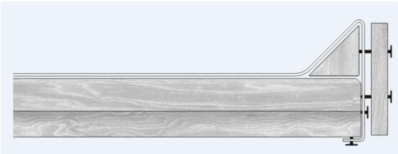
Ortgang mit Holzkeil und Windbrett Mechanisch fixiert.
